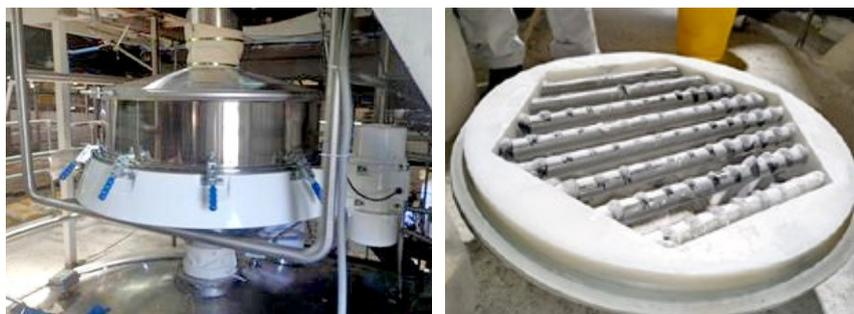
Rejilla magnética de secadora #2 (prueba): pasa de 6000 *gauss* a 14.000 *gauss*.
