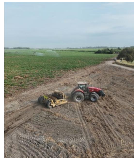
A partir del implemento agrícola acoplado al tractor para la preparación profunda y centralizada del suelo, y el sistema de surcado, en un pase puede subsolar, preparar y surcar el suelo, dejando la preparación óptima para la siembra de la caña. En 2024 se prepararon 33,5 ha con este equipo, el cual presenta una reducción de costos del 30 % con respecto a las labores tradicionales de la preparación.
